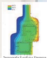
Termografia EuroFutur Elegance
